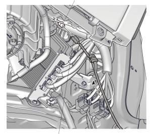
**RIGHT RUNNING** BOARD HARNESS 2-PIN CONNECTOR QE02707BA
