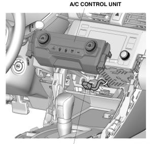
AMBIENT LIGHT HARNESS 12-PIN CONNECTOR QE32314**A**J
