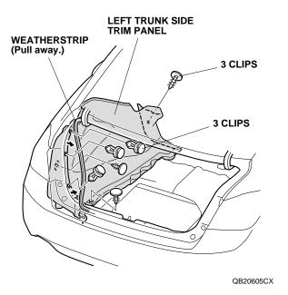
9. If equipped, remove the trunk panel (ten clips).
